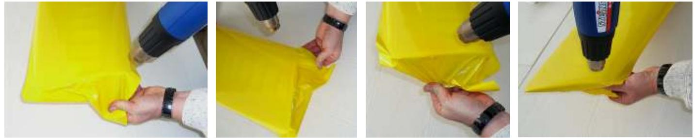
Abb. 11a-d Bespannung des Randbogens
