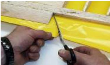
Abb. 12a Für Ecken an der Innenseite erst in einem Winkel von 45° einschneiden,
