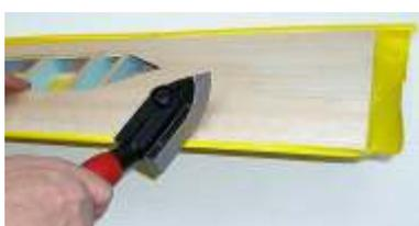
Abb. 10b Bebügelung fertig stellen
