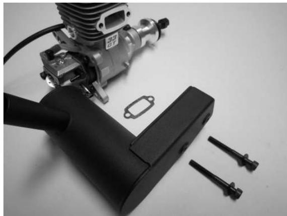
Der Motor wird durch die in der hinteren Abdeckung integrierten vier Halter befestigt. Montieren Sie den Motor direkt auf dem Motorspant. Verwenden Sie Schrauben der Größe M5 falls Sie den Motor mit flexiblen Motorträgern befestigen möchten, achten Sie auf ausreichende Festigkeit und Stärke. Sichern Sie die Schrauben gegen Lockerung und überprüfen Sie regelmäßig, ob sie festsitzen und intakt sind.
