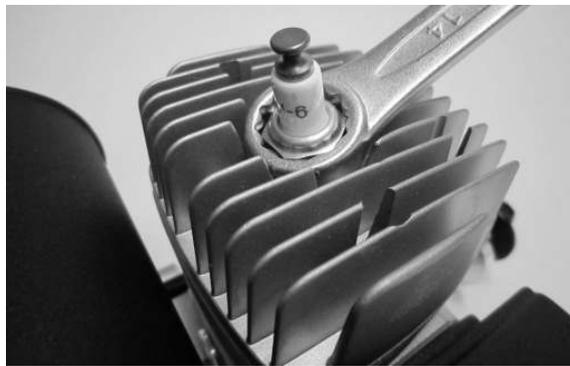
Die Zündkerze vorsichtig von Hand bis Anschlag in den Zylinderkopf eindrehen. Mit einem Ringschlüssel (14 mm) die Zündkerze festziehen.
